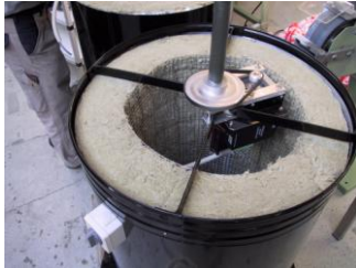
Isoleret rør for motordrevet turbine. Turbine hatten afmonteret her for synligheden
