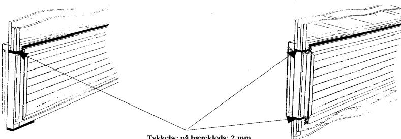
**Indbygningstype A2 med glas over element, C2 med glas over og under element:**
