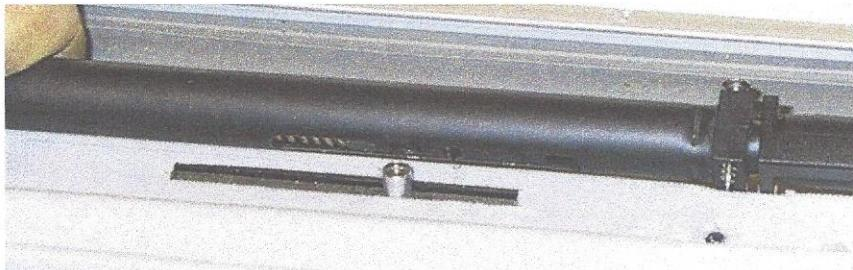
Når voksmotoren er monteret kan eventuelt overskydende ledning samles med en kabelbinder. Se figur.
